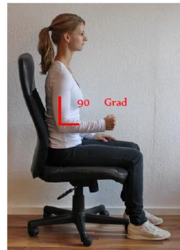
Abbildung 4 Messposition. Während der Messung zählt die untersuchende Person laut („1 – 2 – 3“), wobei bei „1“ die Kraft langsam aufgebaut und bei „3“ die maximale Kraft erreicht sein soll.
